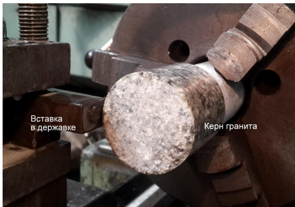
Рисунок 2.6 – Стенд для испытания спеченных образцов на износостойкость
