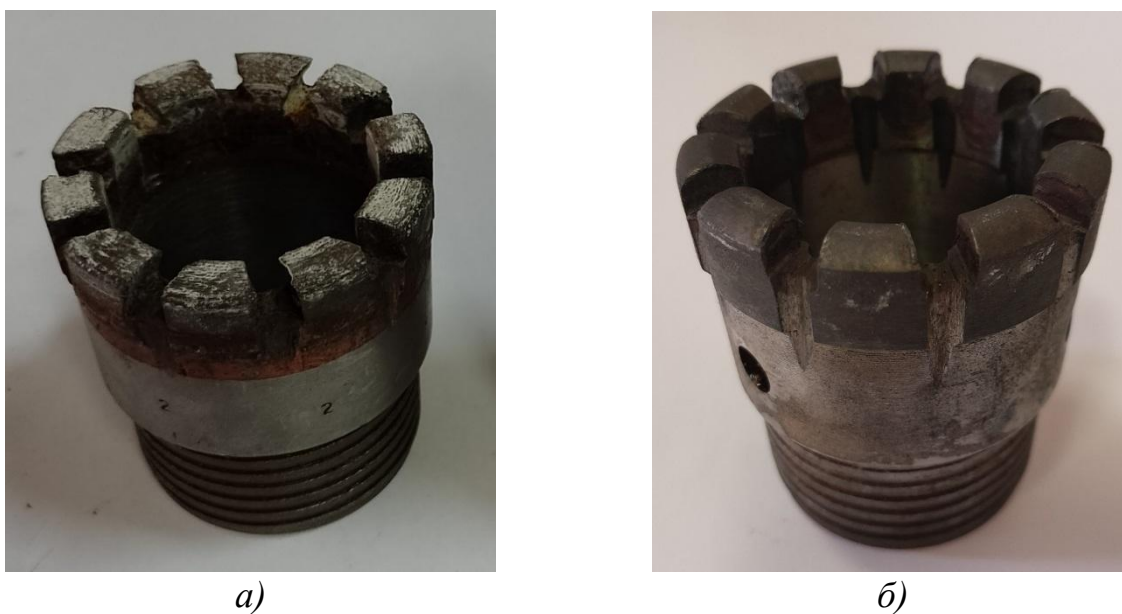
Рисунок 3.18 – Режущая поверхность алмазных импрегнированных коронок 1 (а) и 2 (б) после бурения гранита
