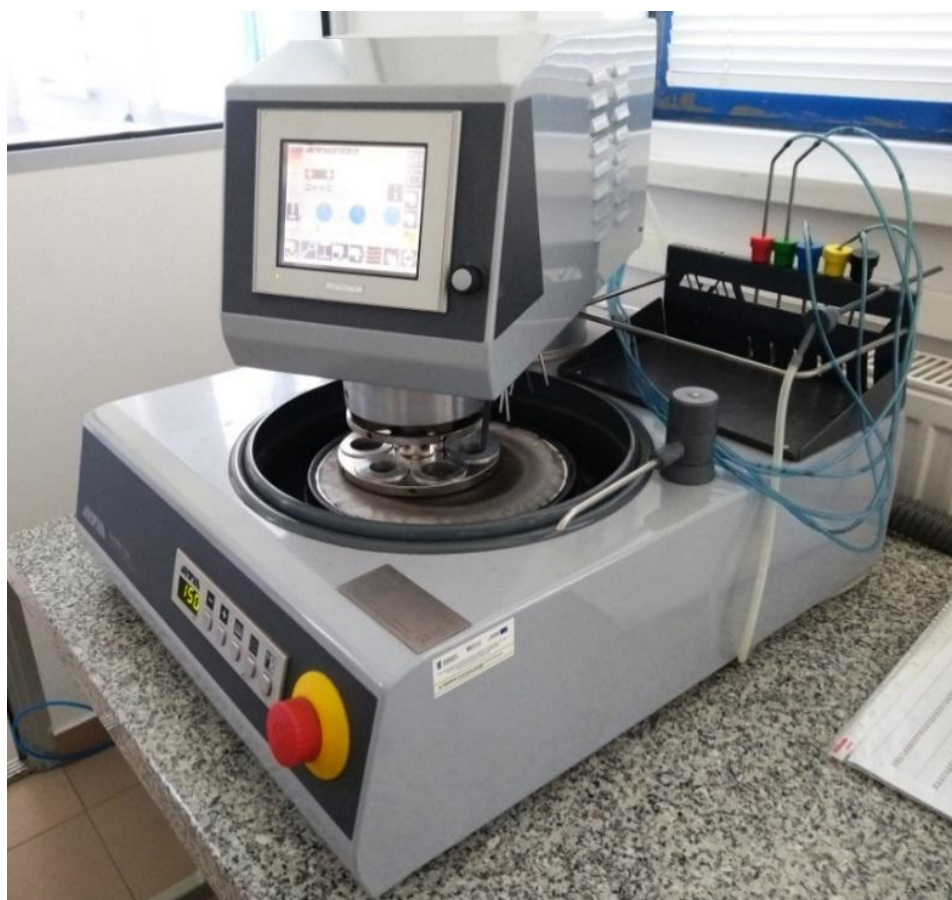
Рисунок 2.2 – Прибор ATM Saphir 550 для полирования шлифованной поверхности спеченных образцов
