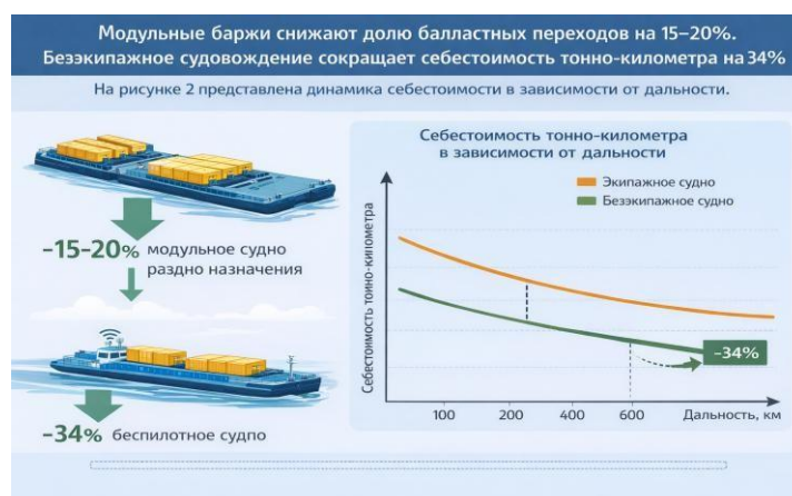
Рисунок 2. Зависимость себестоимости перевозки от расстояния (традиционное и безэкипажное судовождение)
