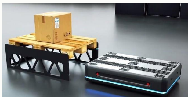
Рисунок 2. Автономный складской логистический робот «Gideon Brothers» (Хорватия)
