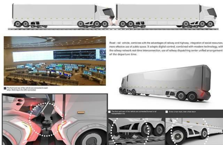
Рисунок 4 - Гибридная транспортная система Rail-Road Vehicle (КНР)
