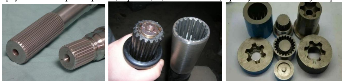
Сурет 1.1 Шлицті қосылыс түрлері
