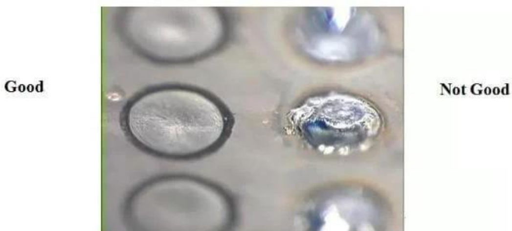
Сурет 4. Суретте нүктелік лазерлік дәнекерлеу сапасының салыстырмасы.
