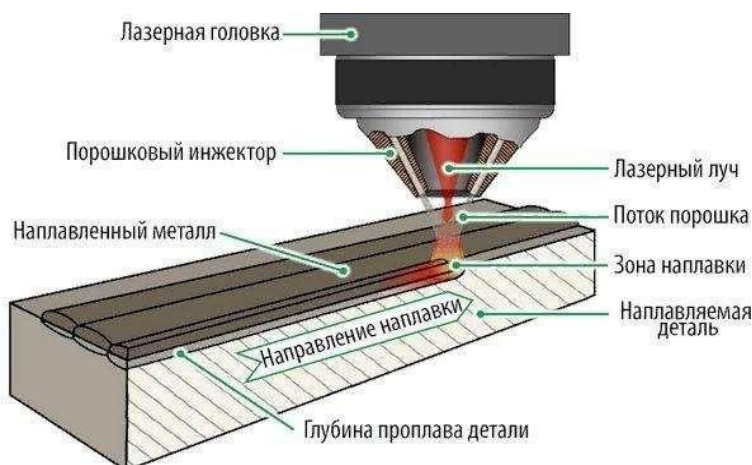
Сурет 1. Бөлшекті лазерлік қаптау технологиясы
