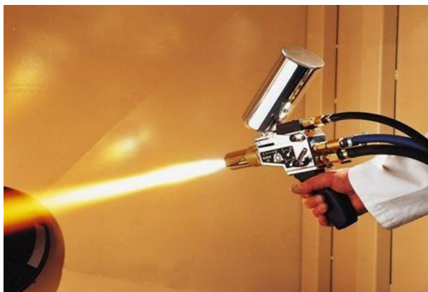
Сурет 1- Термиялық бүрку (Thermal Spray) процесі
