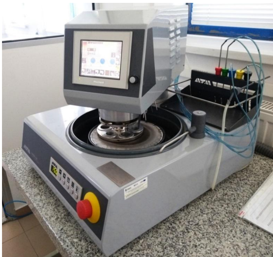
Рисунок 3.2 – Прибор ATM Saphir 550 для полирования шлифованной поверхности спеченных образцов
