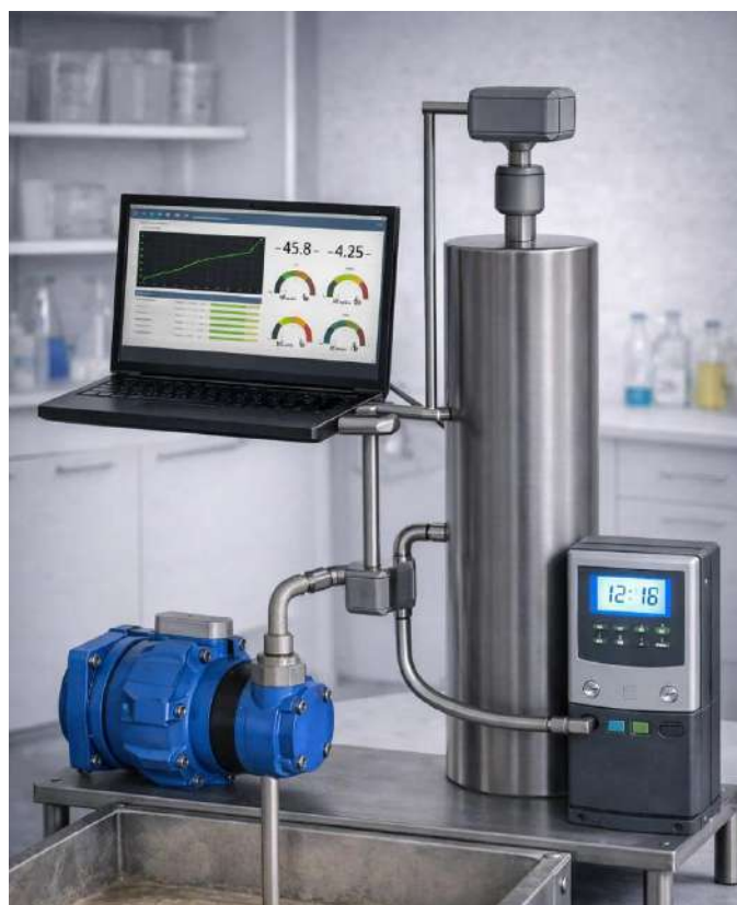
Рисунок 4.1 – Система для автоматического измерения плотности бурового раствора
