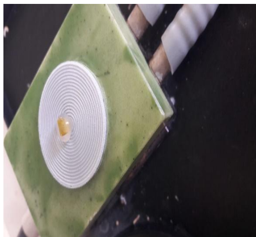
Сурет 23 – ТОС-2 мұздатқыш қондырғысы бар микротоммен жапырақ тақтасының ортаңғы бөлігінен кесілген үлгілер
