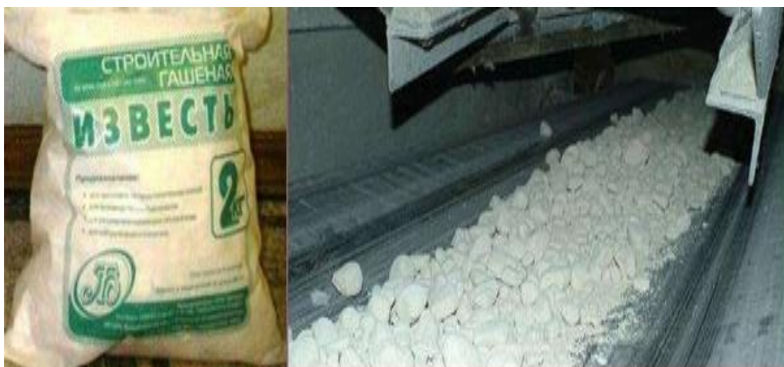
Рисунок В.2 - Получение оксида кальция путём обжига карбонатов
