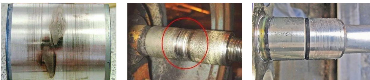
Сурет 1.2 Айналмалы дене түріндегі бөлшектердің тозған беттер
