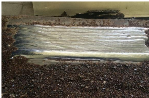
Сурет 1.3 – СВ08ХГ2СМФ маркалы сыммен қорғаныш газ ортасында (CO 2 -100%) жартылай автоматты балқытумен орындалған үлгілер
