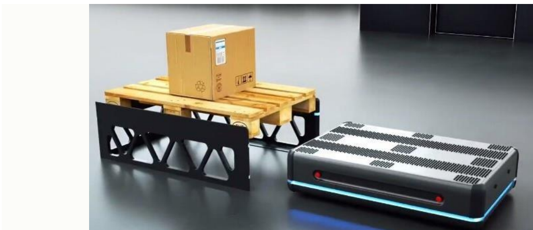
Рисунок 2 - Автономный складской логистический робот «Gideon Brothers» (Хорватия)
