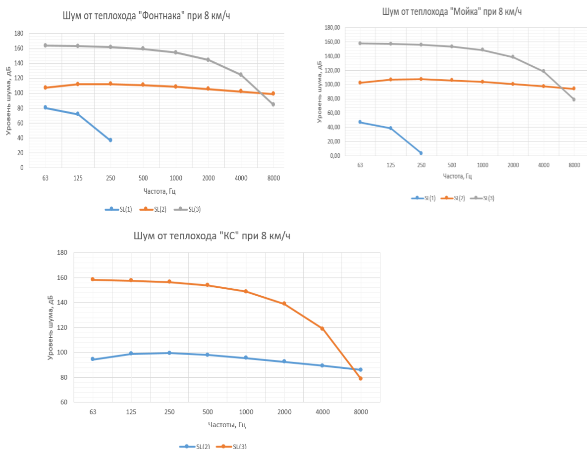
Рисунок 3. Уровни звукового давления от теплоходов при 8 км/ч, где SL(1) – шум от низкочастотной кавитации, SL(2) – шум от высокочастотной кавитации, SL(3) – шум от оборудования
