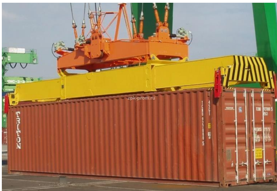
Рисунок 2. Спредер для перегрузки крупнотоннажных контейнеров
