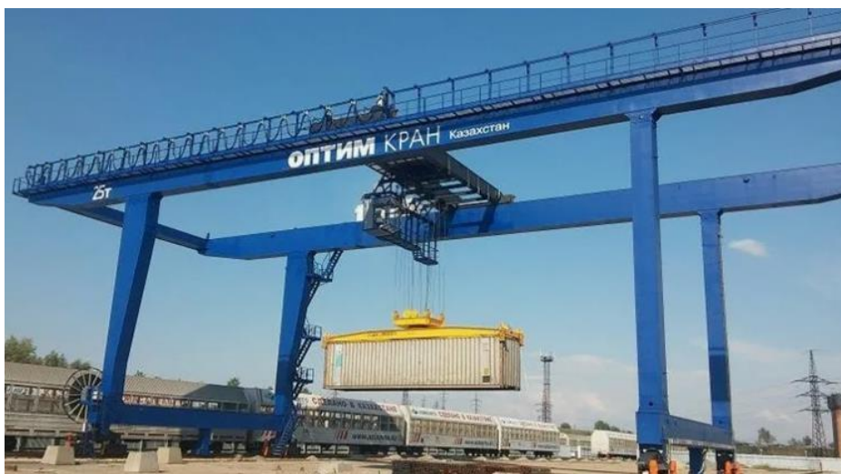
Рисунок 3. Козловой контейнерный кран для перевалки контейнеров
