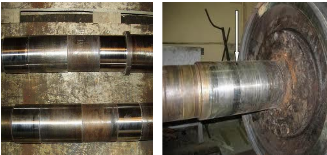
Сурет 2 - Біліктің әртүрлі аймақтарындағы ақаулардың түрлері
