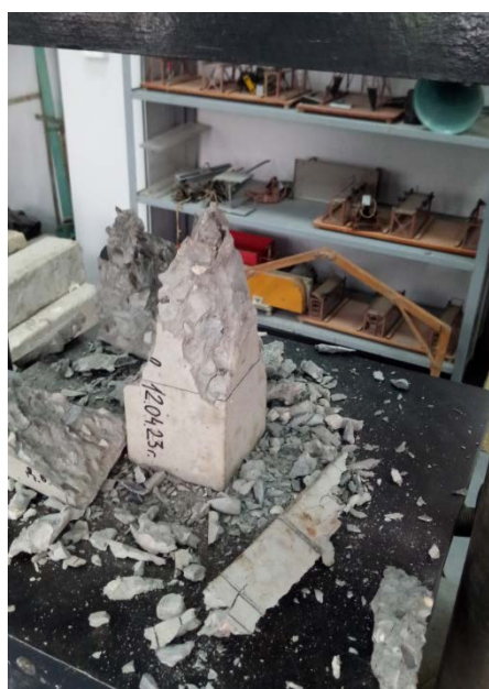
Рис.8 Призма 10*10*40см (состав бетона №3) после разрушения
