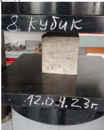
Рис.6 Образец 15*15*15см (состав бетона №3) 7 дней выдержки до разрушения
