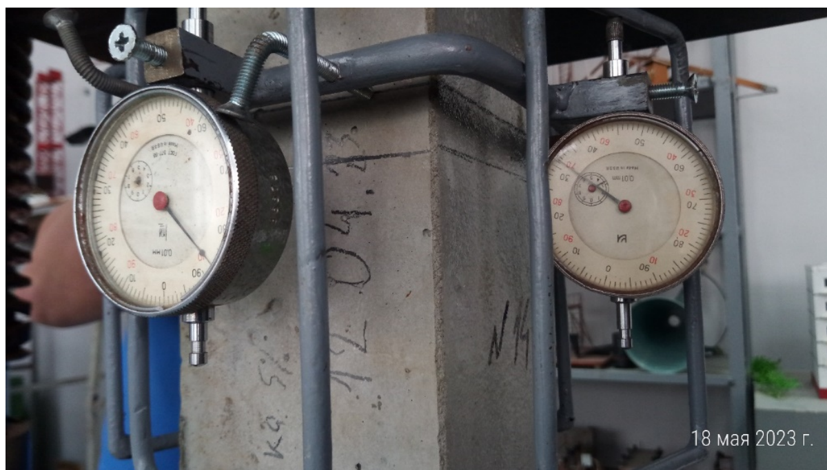
Рис. 10 Испытание призмы 10*10*40см (состав №3) для определения модуля упругости бетона
