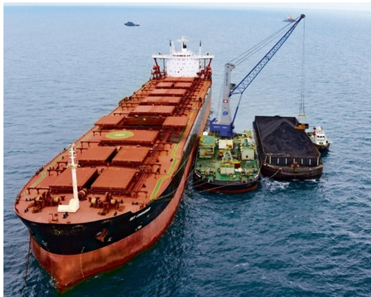
Рисунок 2. Догрузка судна сыпучими грузами по варианту судно - судно
