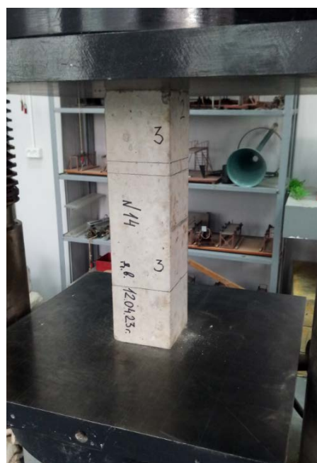
Рис.9 Призма 10*10*40см (состав бетона №3) до разрушения
