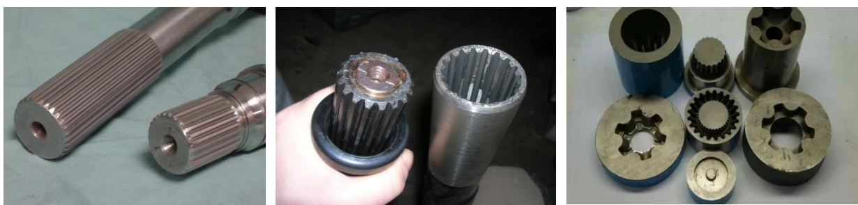
Сурет 1.1 Шлицті қосылыс түрлері
