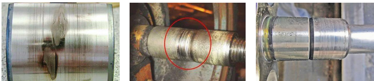
Сурет 1.2 Айналмалы дене түріндегі бөлшектердің тозған беттер
