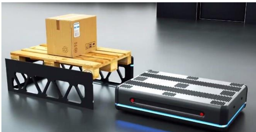
Рисунок 2 - Автономный складской логистический робот «Gideon Brothers» (Хорватия)
