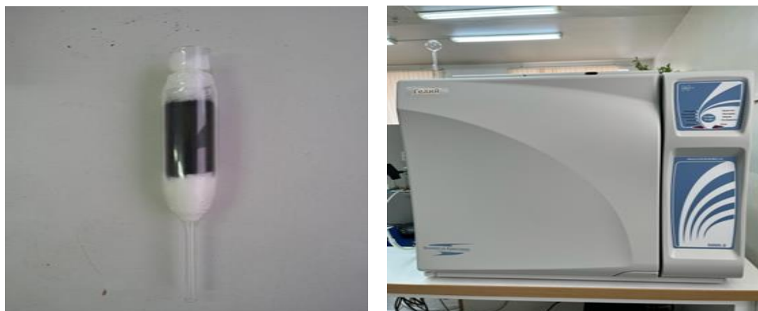
Сурет – 3. «Хроматэк-Кристалл-500» хроматографы және шыны колонка
