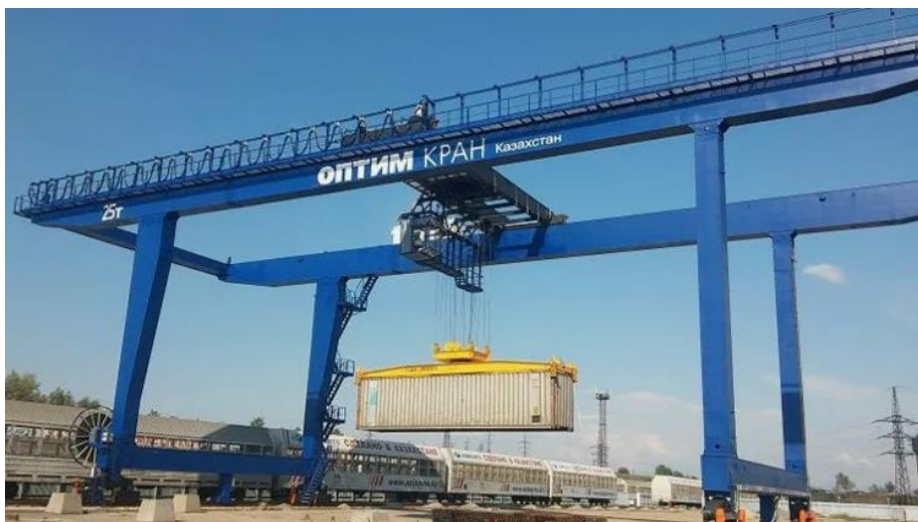
Рисунок 3. Козловой контейнерный кран для перевалки контейнеров
