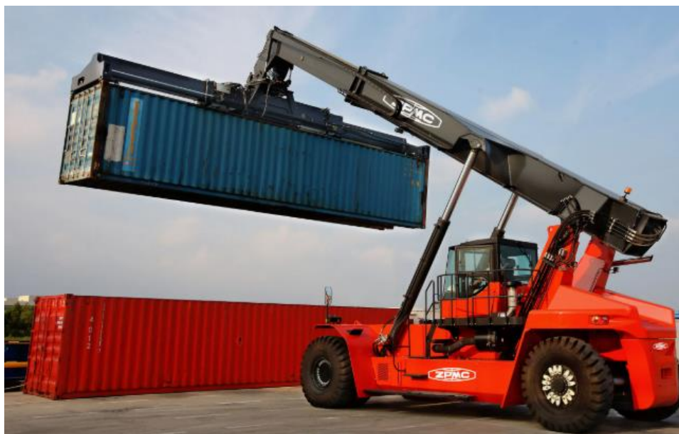
Рисунок 4. Ричстакер для перегрузки контейнеров
