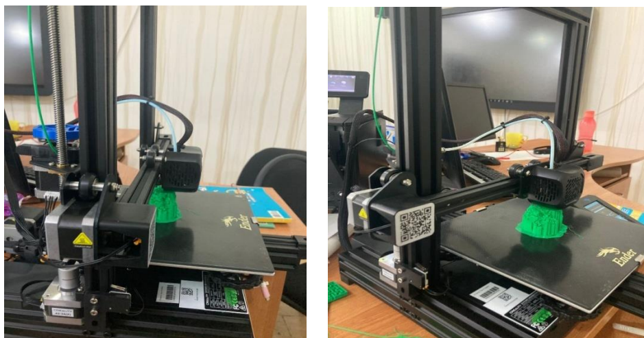
2-сурет. 3D принтермен құрастырылған гемоглобиннің моделі
