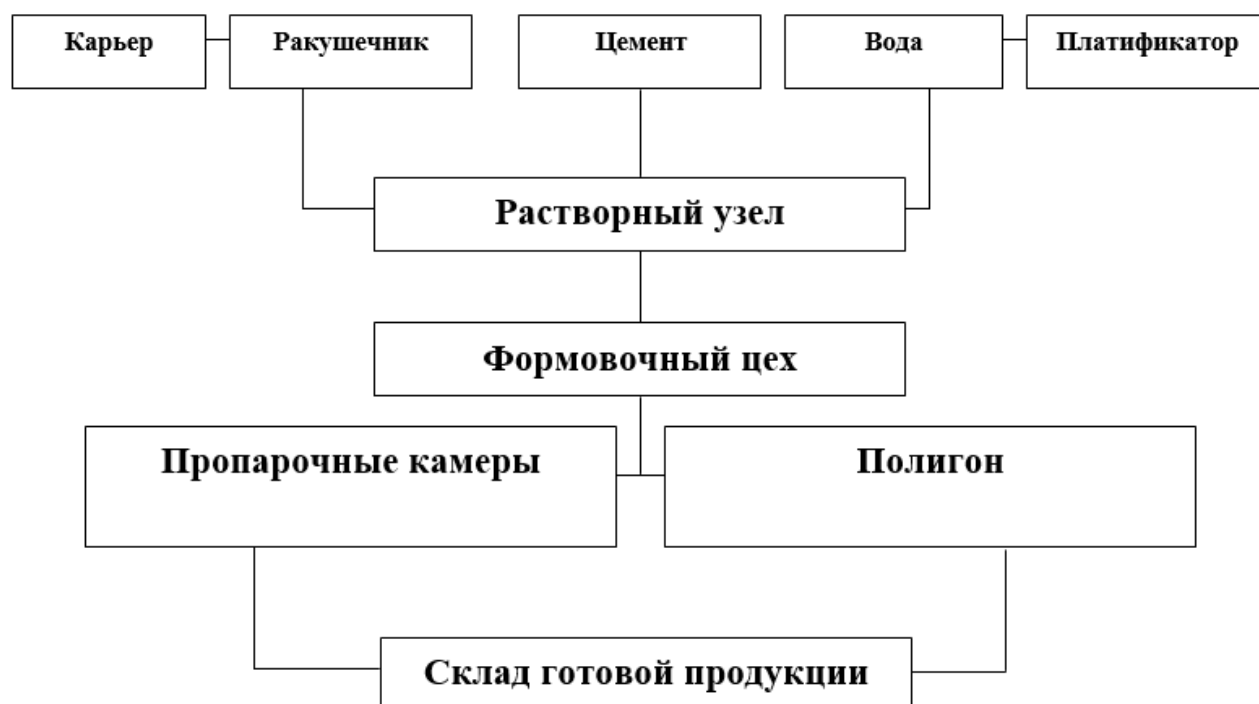
Рисунок 34 - Технологическая схема производства бетонных изделий на полигоне ТОО «Firma Fial»
