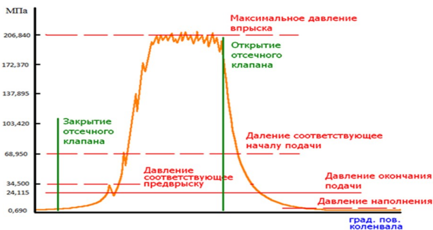
Рисунок 4. Условные фазы рабочего цикла насос-форсунки.
