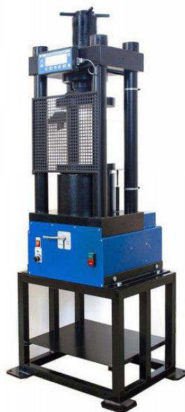
Рисунок 18 – Пресс для проведения испытаний на сжатие
