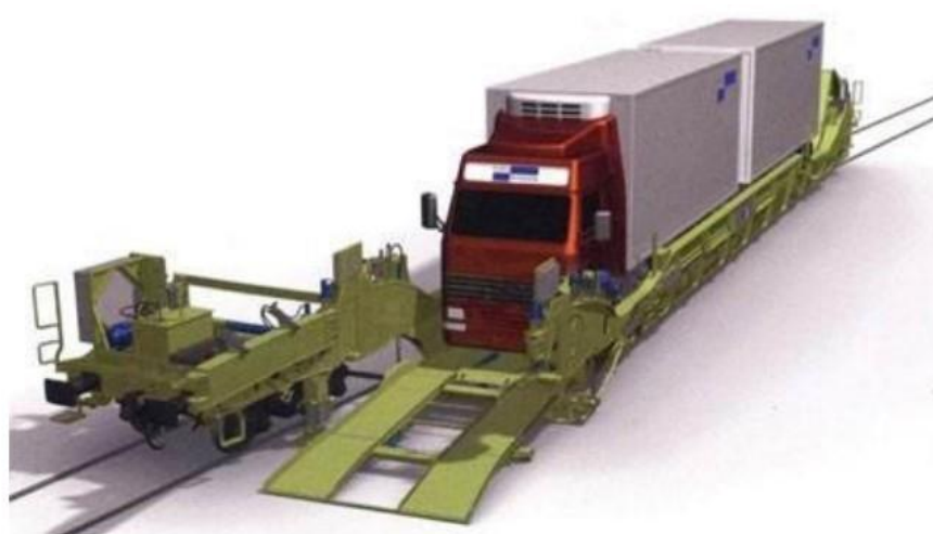
Рисунок 3 - Поворотная платформа системы «Flexiwaggon»
