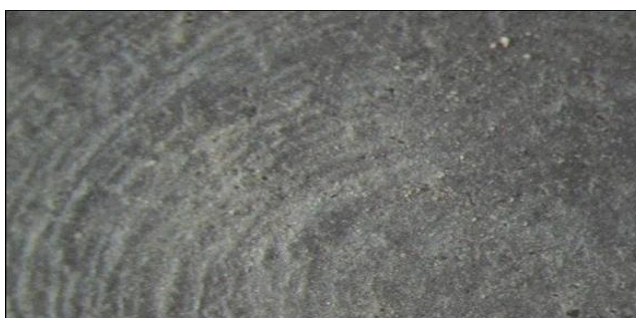
Сурет 6.9 - Престоу технологиясы бойынша алюминий хлоридімен модификацияланған топырақ негізіндегі күкіртті композициялық материалдың бетінің микрографиясы
