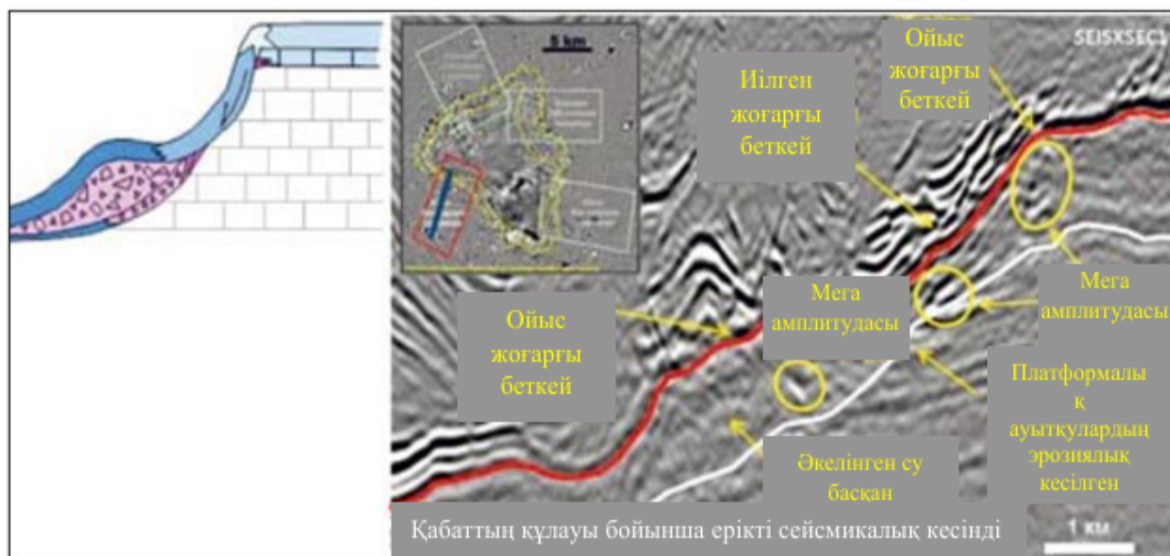
Сурет 4.9 - Оңтүстік-Батыс шекарасы платформаның бортының жаппай құлауын және орташа және төменгі беткейге дейін айтарлықтай брекчи шөгінділерін көрсетеді. МЕГА-амплитудалық құбылыстар платформаның жоғарғы және төменгі беткейлерімен шектелген
