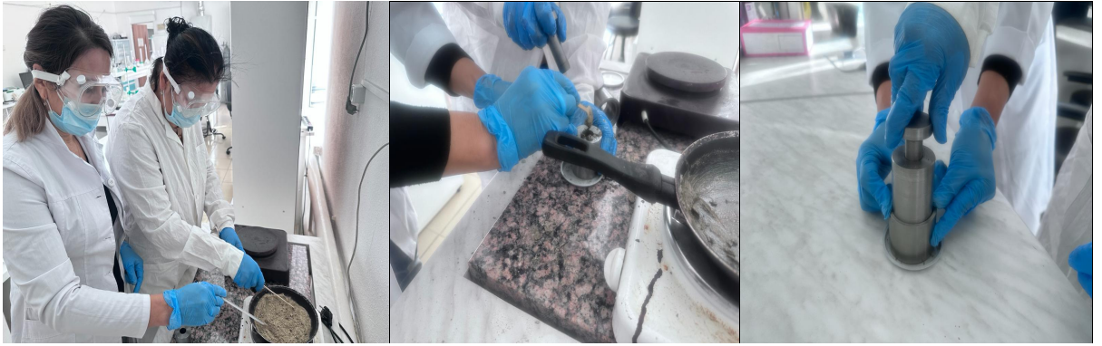
Сурет 6.7 – Күкіртті композициялық материалдар негізінде тампонажды ерітінді қоспасын жасау технологиясы
