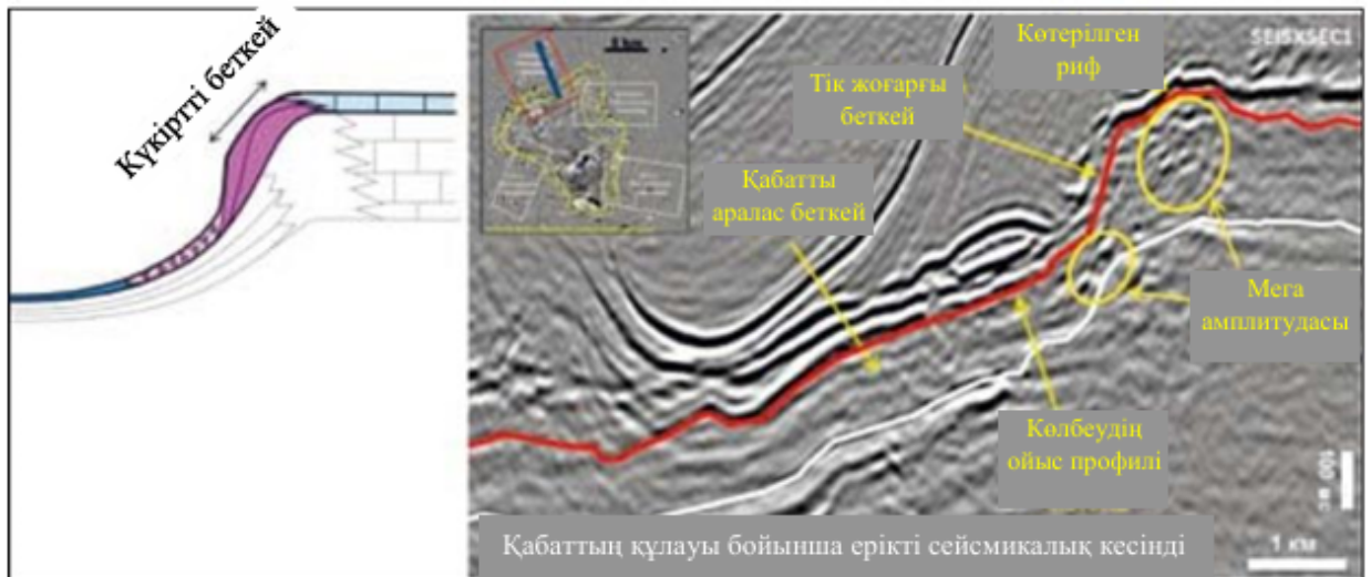
Сурет 4.10 - Солтүстік-Батыс шекарада жыра тәрізді жоғарғы беткей және шектелген брекчий шөгіндісі бар қабаттасқан төменгі беткей көрсетілген. Ерте матрицалық цементтеуге байланысты көлбеу (50°)
