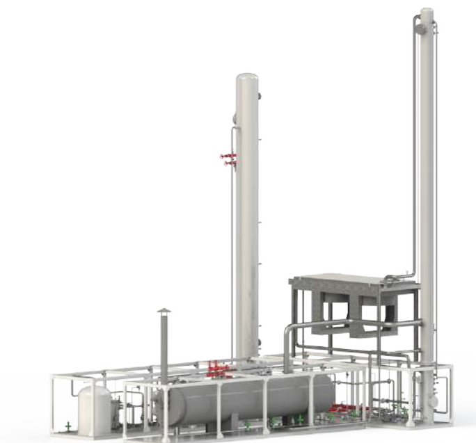
Сурет 5.1 - Газды күкіртті сутектен тазартудың аминдік қондырғысы
