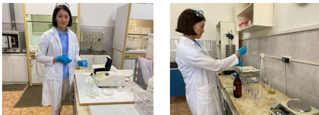
Сурет И.3 – ЖШС «Қоршаған ортаны қорғау бойынша аналитикалық зертханада» топырақ құрамында күкірт құрамын анықтау
