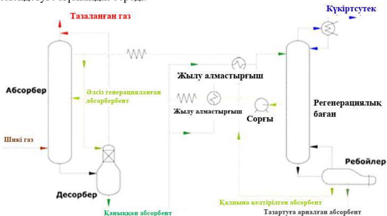
Сурет 5.2 - Газды күкіртті сутектен тазартудың аминдік сызбасы
