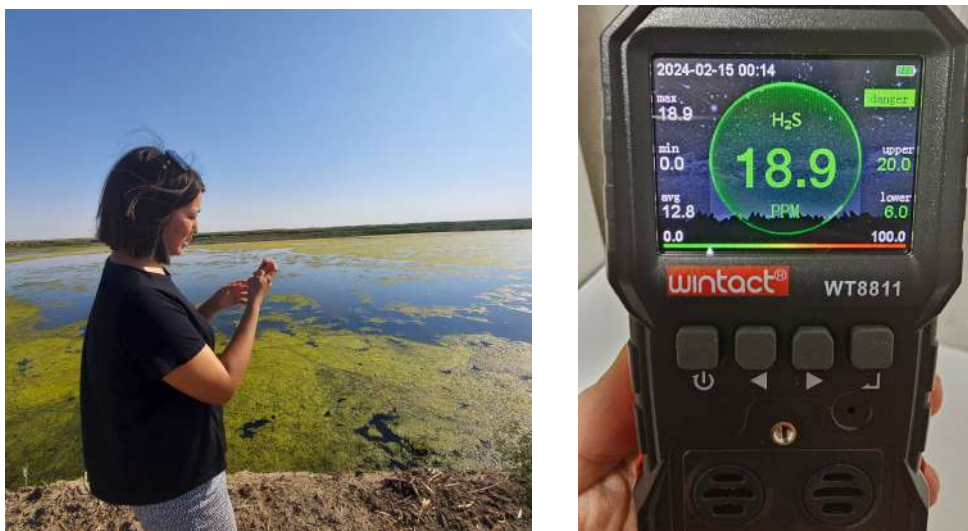
Сурет И.1 – «Тухлая балка» булану аймағында күкіртсутекті WT8811 көп компонентті газ анализатормен өлшеу
