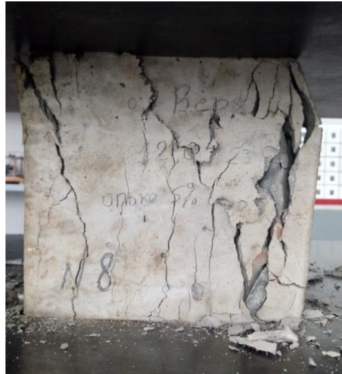
Рис.7 Образец 15*15*15см (состав бетона №3) 7 дней выдержки после разрушения
