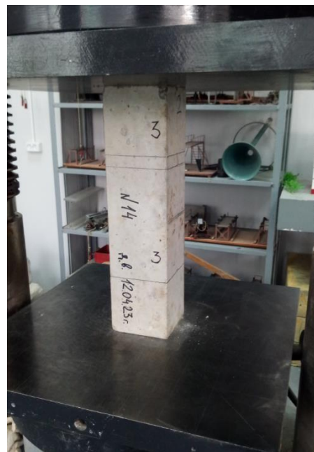
Рис.9 Призма 10*10*40см (состав бетона №3) до разрушения
