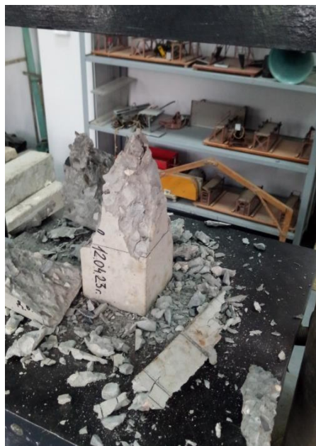
Рис.8 Призма 10*10*40см (состав бетона №3) после разрушения
