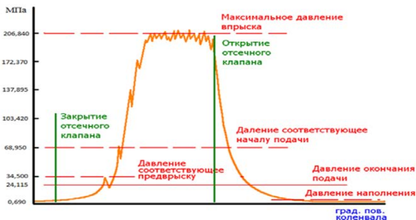
Рисунок 4. Условные фазы рабочего цикла насос-форсунки.
