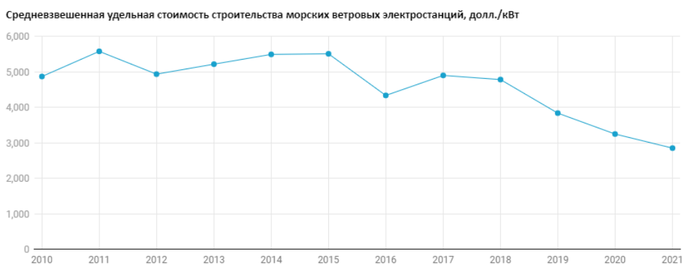
Рисунок 3. Средневзвешенная удельная стоимость строительства морских ветровых электростанций, долл./кВт
