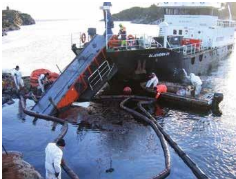
Рисунок 3. Ленточный скиммер, установленный на большом судне
