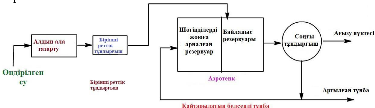
Сурет 3 – Алдыңғы [65] зерттеулерге негізделген биологиялық тазарту процесінің сызба-нұсқасы
