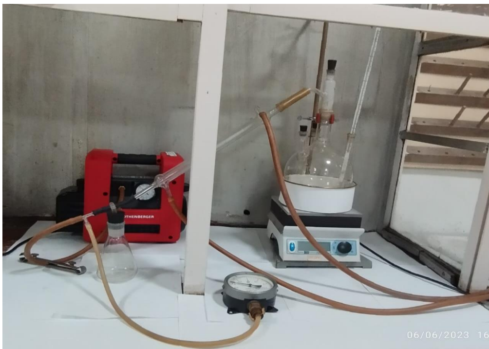
Сурет 19 – Сарқынды суды буландыруға арналған қондырғылар тізбегі
