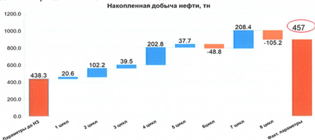
Рисунок 3 – Динамика добычи нефти до и после циклического заводнения
