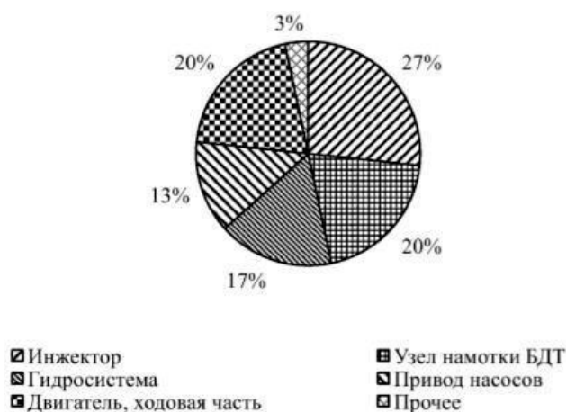
Рисунок 2 - Отказы КГТ в отдельных узлах
