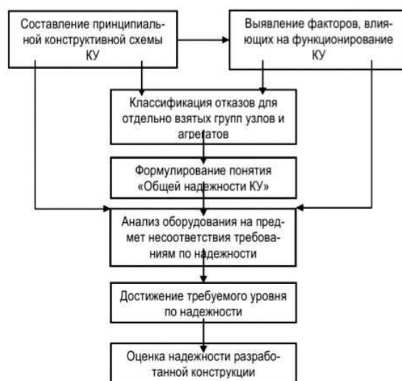
Рисунок 3 - Алгоритм анализа надежности колтюбинговой установки
