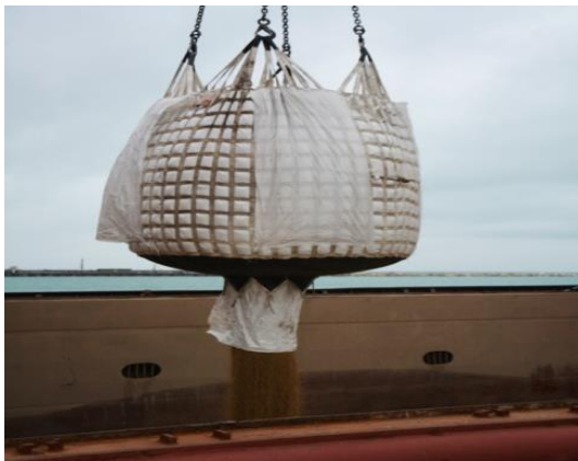
Рисунок 3 - Погрузка зерна на судно 10-тонными, биг-бэгами”
