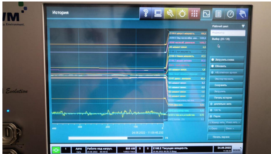
Рисунок 3 – панель управления газопоршневыми генераторами
