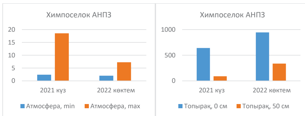
Сурет 5 - Химпоселок АНПЗ нүктесінде ауа құрамындағы күкіртті сутегі және топырақтағы күкірттің мөлшері
