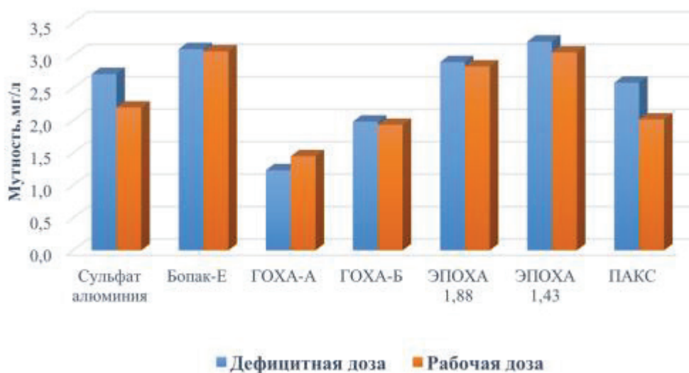
Рисунок 1 - Средние значения мутности воды после пробного коагулирования
