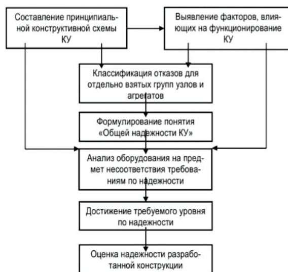
Рисунок 3 - Алгоритм анализа надежности колтюбинговой установки
