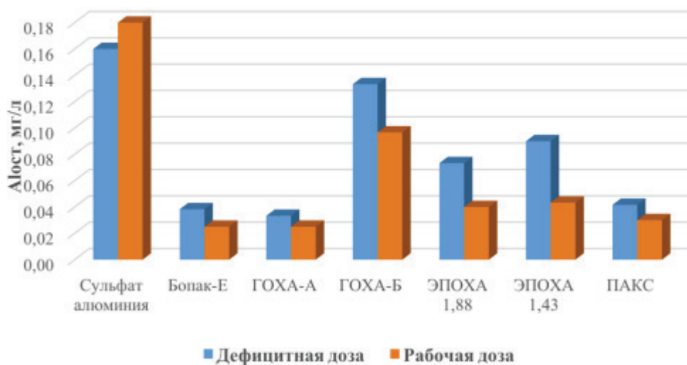
Рисунок 2 - Средние значения содержания остаточного алюминия в воде после пробного коагулирования
