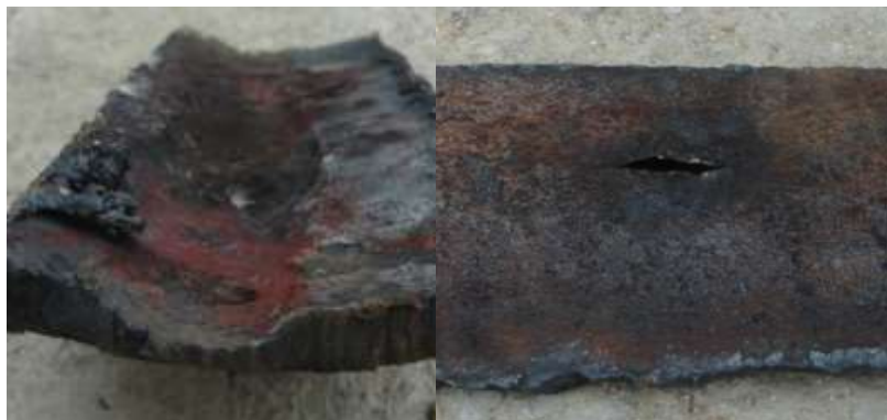
Сурет 1 – Жұмыс істемейтін құбыр материалының коррозия түрі
