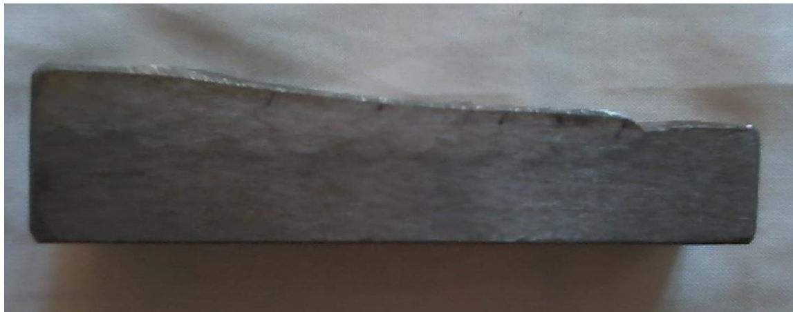
Сурет 1 - Болатты екінші қабатпен қаптағаннан кейінгі сызат саны мен өлшемі
