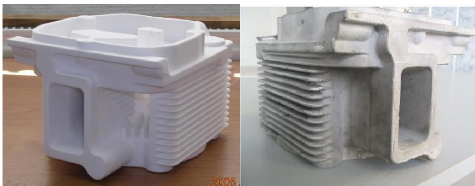
Сурет 2 - Полистирольді үлгі және ІЖҚ цилиндрінің бастиегінің құймасы
