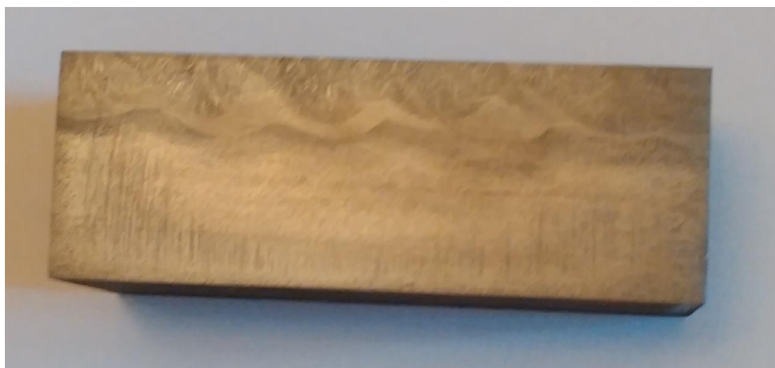
Сурет 2 - Пластикалық деформацияға ұшырағаннан кейінгі сызатсыз үлгі
