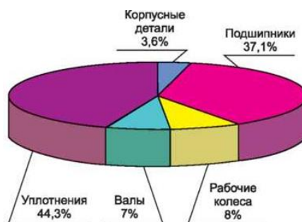
Рисунок 2 - Диаграмма распределения повреждений по элементам насосов
