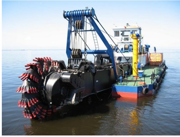
Сурет 1 - Роторлы-траншеялы жабдығы бар түбін тереңдету кемесі
