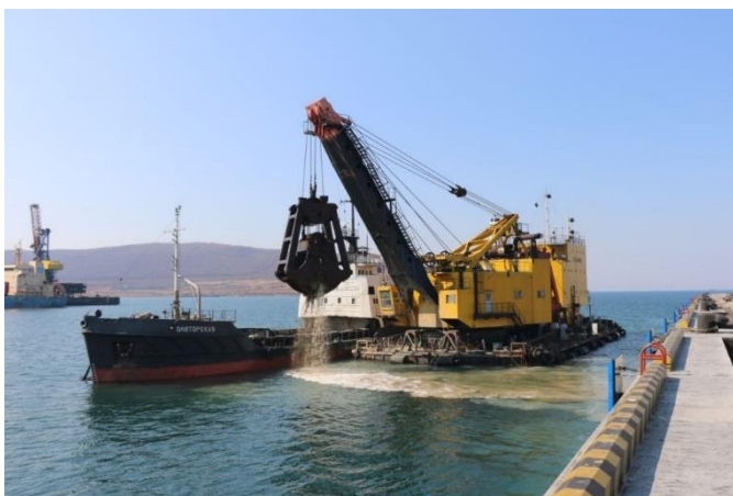
Рисунок 3 - Грейферный землечерпательный снаряд
