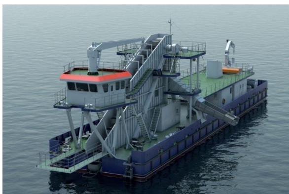
Рисунок 4 - Многочерпаковый землечерпательный снаряд
