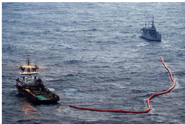
Рисунок 2 - Ограждение нефтяного пятна оперативными бонами
