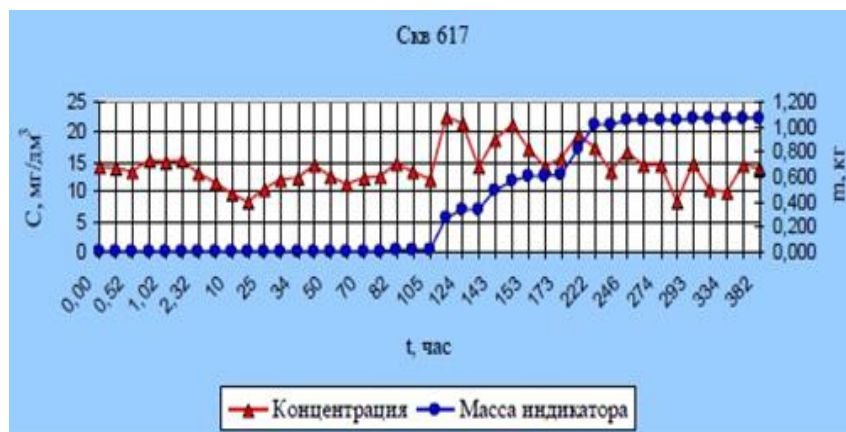
Сурет 3 - Қабат суымен ағып өтудің концентрациясы және индикатордың жинақталған массасы
