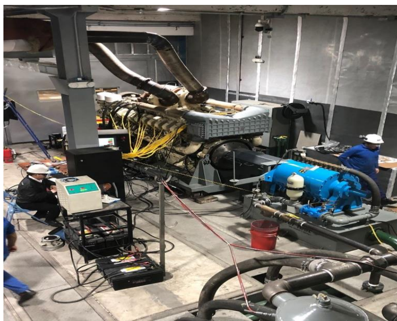
Рисунок 6 - Двигатель с подключенными датчиками
