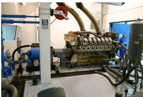
Рисунок 3 - Стенд для испытания судовых ДВС с гидротормозом и охлаждающей колонной
