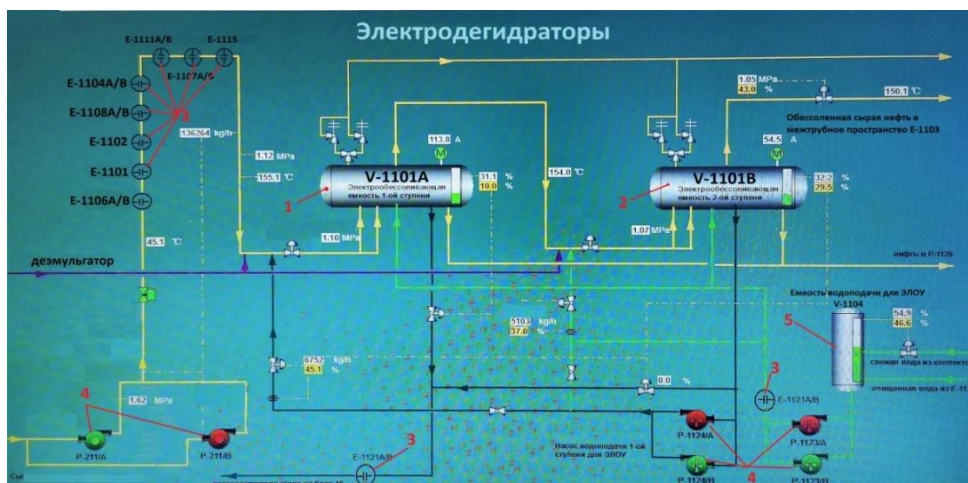
Рисунок 1 - ЭЛОУ - Электрообессоливающая и обезвоживающая установка
