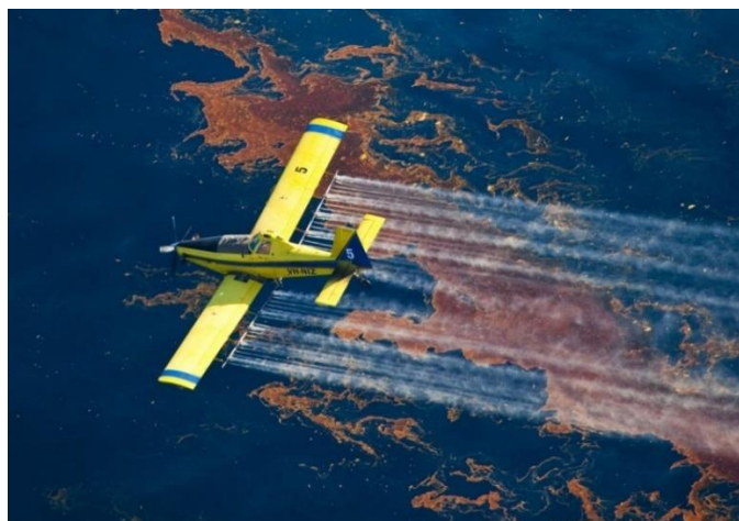
Рисунок 3 - Распыление диспергентов на нефтяное пятно
