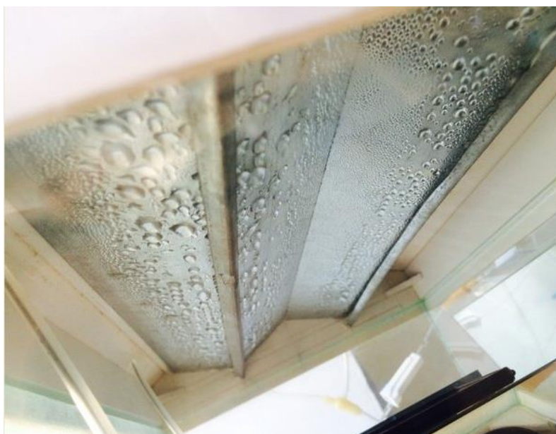
Рисунок 1 – Фрагмент вида разработанного опреснителя (процесс перетока увеличенных капель в конденсатосбоник)
