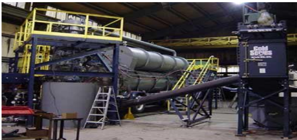
Рисунок 1 - Термодесорбционная система с трехфазным шнековым транспортом
