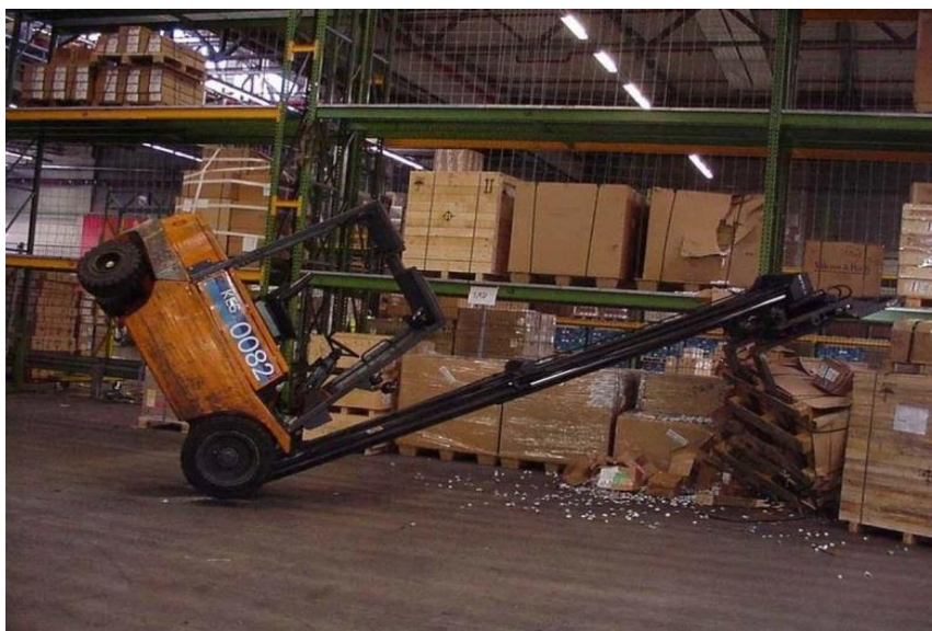
Рисунок1 - Опрокидывание погрузчика при подъеме номинального груза на максимальную высоту
