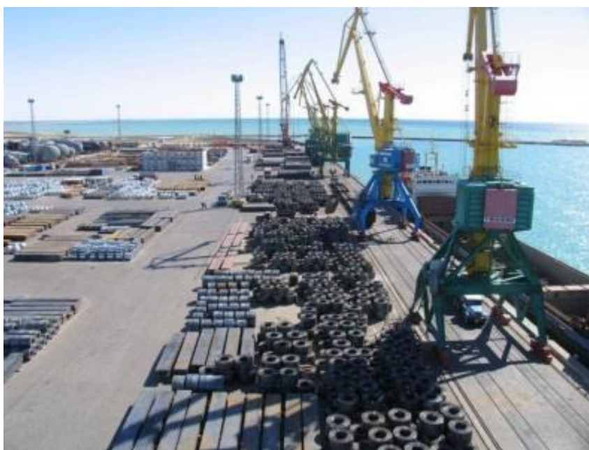
Рисунок 1 - Складирование металла в один ярус на складе открытого хранения порта Актау
