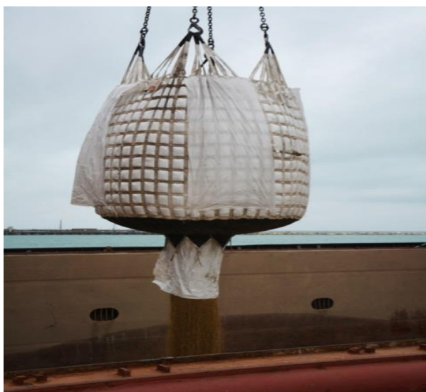
Рисунок 1 - Погрузка зерна на судно «Торик» 10-тонными “биг-бэгами”
