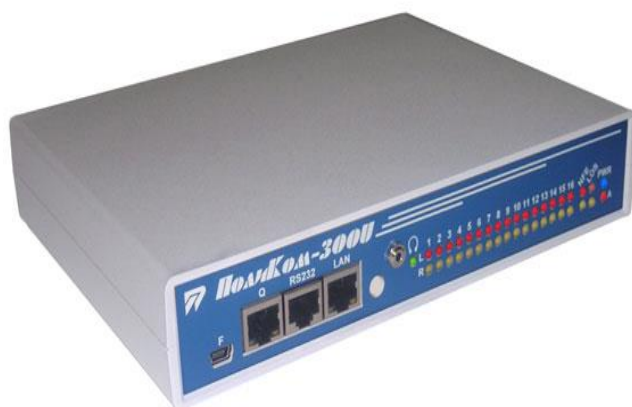
Рисунок 9 - Прибор для концентрации и передачи сигналов – мультиплексор
