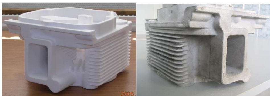
2 сурет - Полистирольді үлгі және ЖК цилиндрінің бастиегінің құймасы
