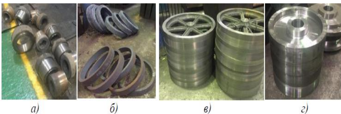
а – рольганг аунақшасының бөшкесі; б – тісті сақина; в – шкивтер; г-сорғылардың дөңгелектері
