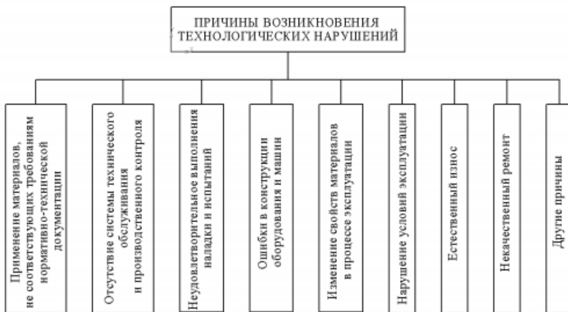
Рисунок 2 – Классификация технологических нарушений по причинам их возникновения
