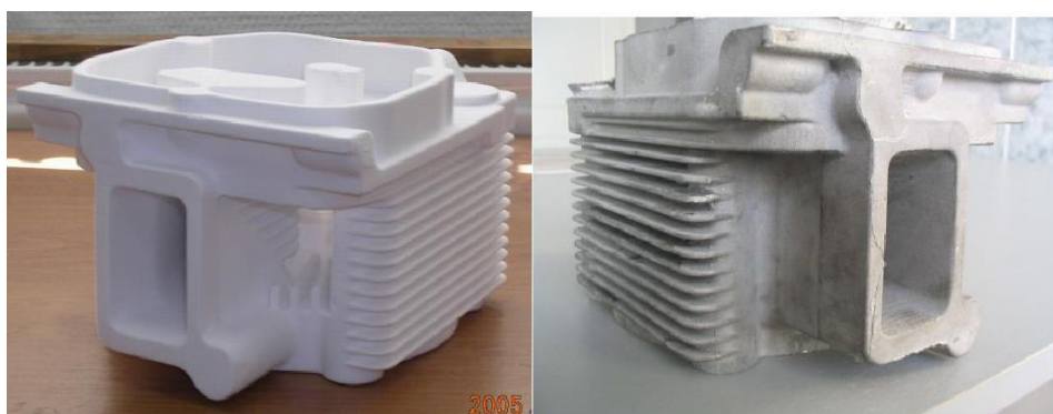
Рисунок 2 - Полистирольная модель и отливка головки цилиндра ДВС
