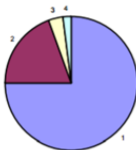
Рисунок 1. Доля дефектов по причинам возникновения, %: 1 – дефекты несоответствия размеров, 75,0; 2 – дефекты формы, 19,5; 3 – дефекты нарушения целостности, 3,5; 4 – дефекты физико-механических свойств, 2,0
