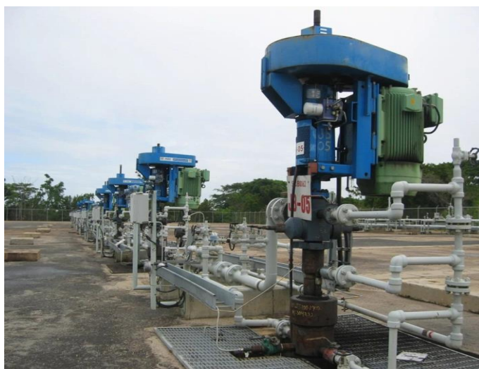
Рисунок 1 – Общий вид электропривода винтового насоса
