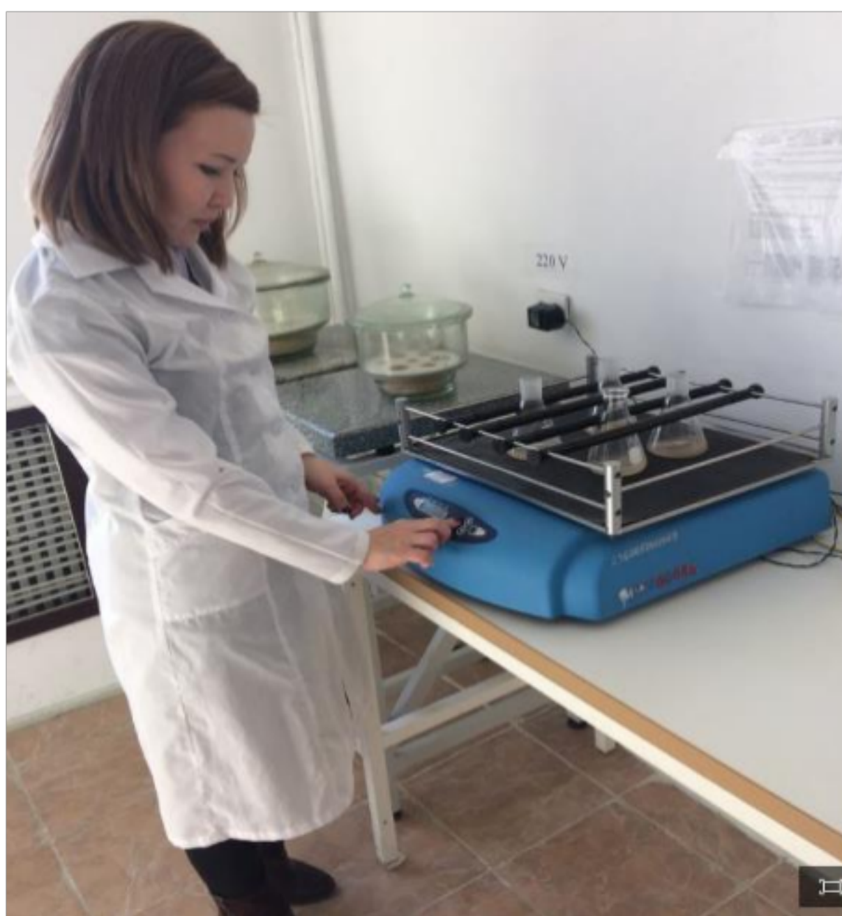
Рисунок 47 – Процесс приготовления водной вытяжки образцов почв
